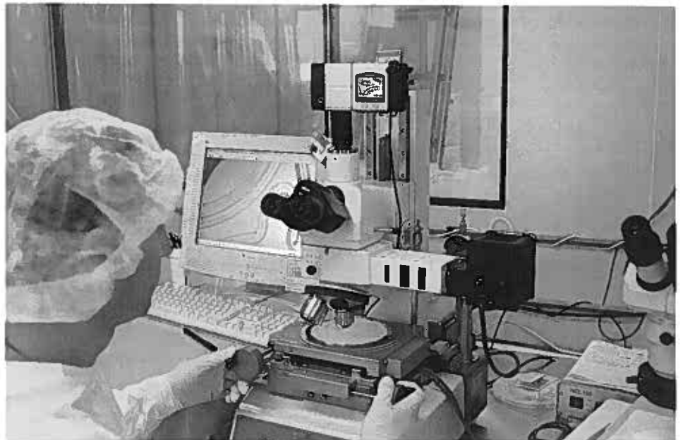
Qualitätskontrolle: Die Platte mit den Uhrwerkskomponenten wird bei Sigatec überprüft.
