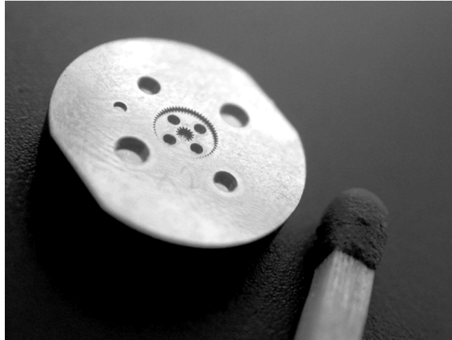
Figure 1. Empreinte « planche – pignon » constituée d'un empilement de deux niveaux électroformés simultanément.
