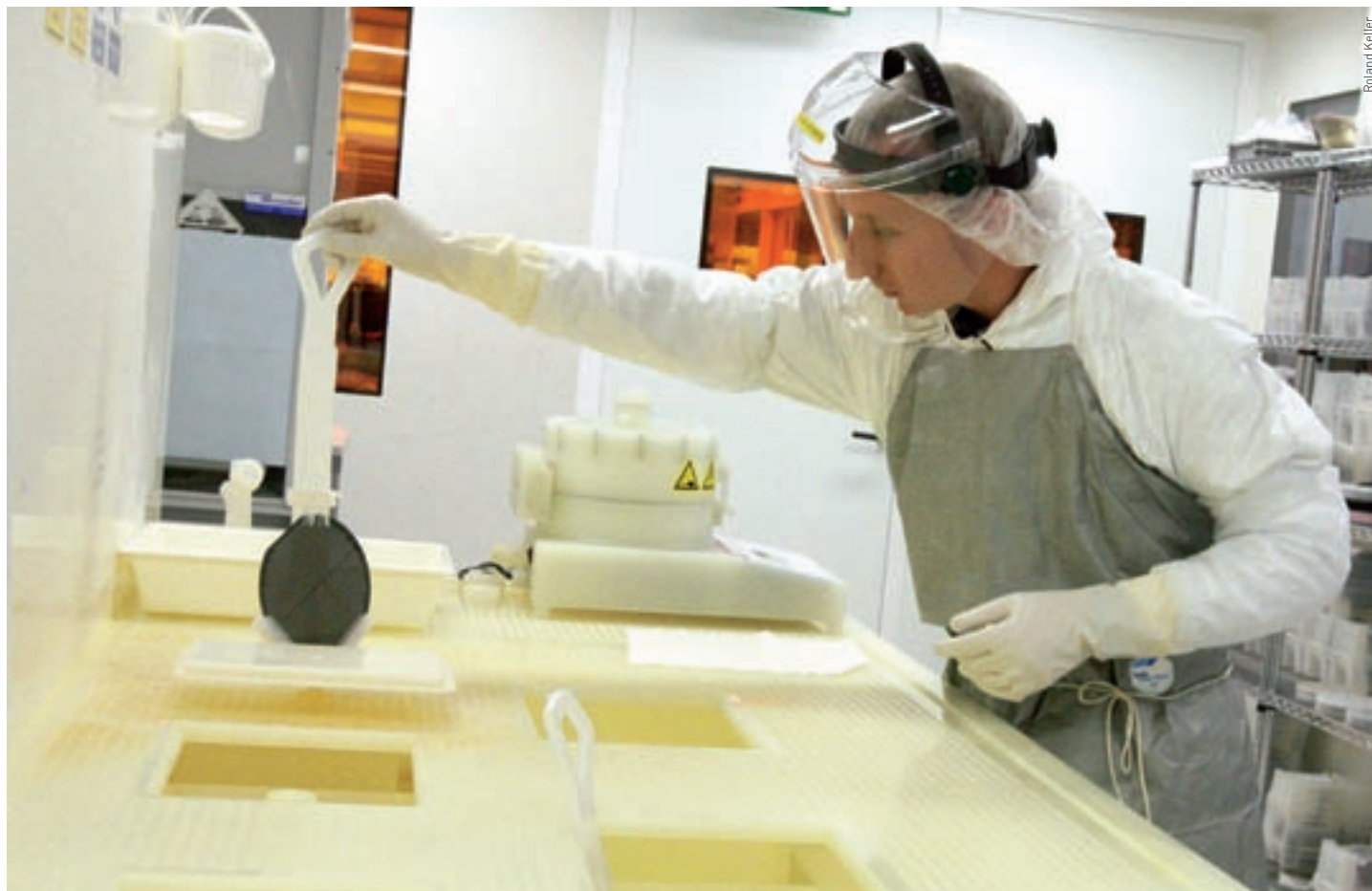
Nettoyage de wafers siliciums après gravure.
